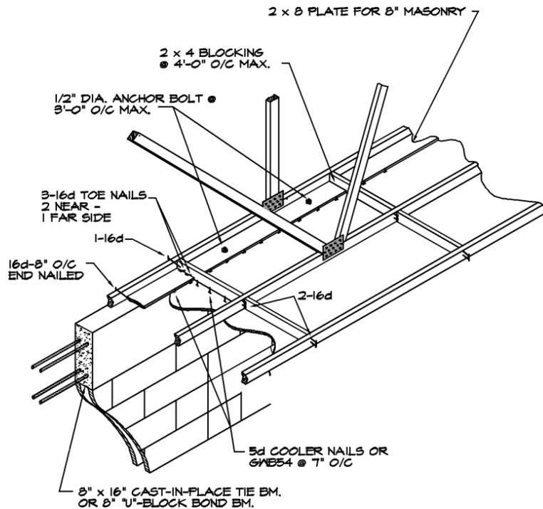
DIRECT TRUSS TO MASONRY ENDWALL (6)
