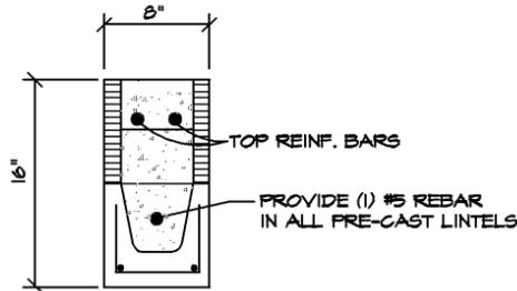
TYP. CONC. BOND BEAM DETAIL W/
