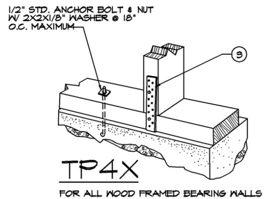
TOP PLATE ANCHORS FOR USE AT BOTTOM PLATE (6) S1 N.T.S.
